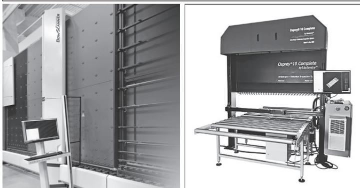
④透明板ガラス製品全ての欠点を検査する「ラインスキャナー」⑤ガラスの反り全体を検査する「ボウスキャナー」（左）、ひずみ・異方性を測定する「オスプレイ10・コンプリート」
